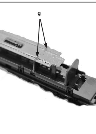
Es wird empfohlen, die Kontaktbügel auf der Leiterplatte zu verlöten **g**, um eine sichere und unterbrechungsfreie Kontaktierung zu gewährleisten.
