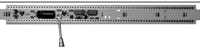
Mit einem geeigneten Schraubendreher kann die gewünschte Helligkeit am Potentiometer eingestellt werden.
