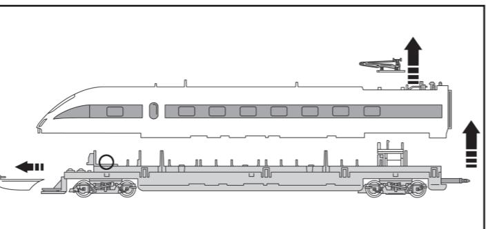
1. Bugklappe und Pantograf abnehmen wie abgebildet.
